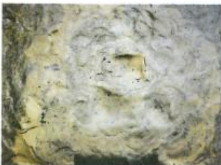
图二十二: 背衬材料上弹坑形状
