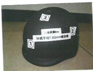
图一：常温条件下，FDK2F-SMS01 型 防弹头盔正面弹伤状态
