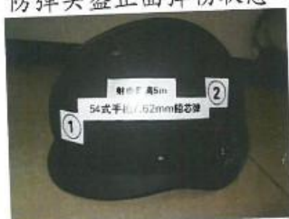
图三：高温条件下，FDK2F-SMS01 型 防弹头盔正面弹伤状态
