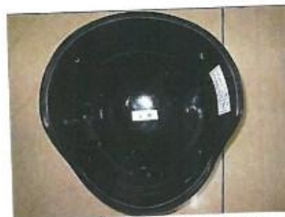
图四：防弹头盔背面弹伤状态
