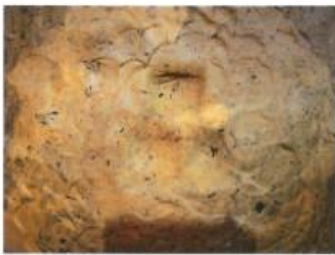
图六: 背衬材料上弹坑形状
