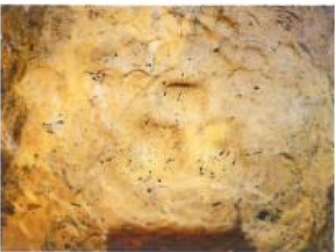
图八: 背衬材料上弹坑形状
