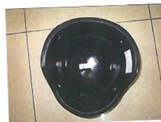
图八：防弹头盔背面弹伤状态
