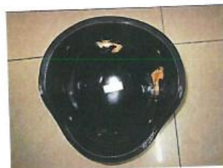
图六：防弹头盔背面弹伤状态
