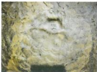
图十六: 背衬材料上弹坑形状
